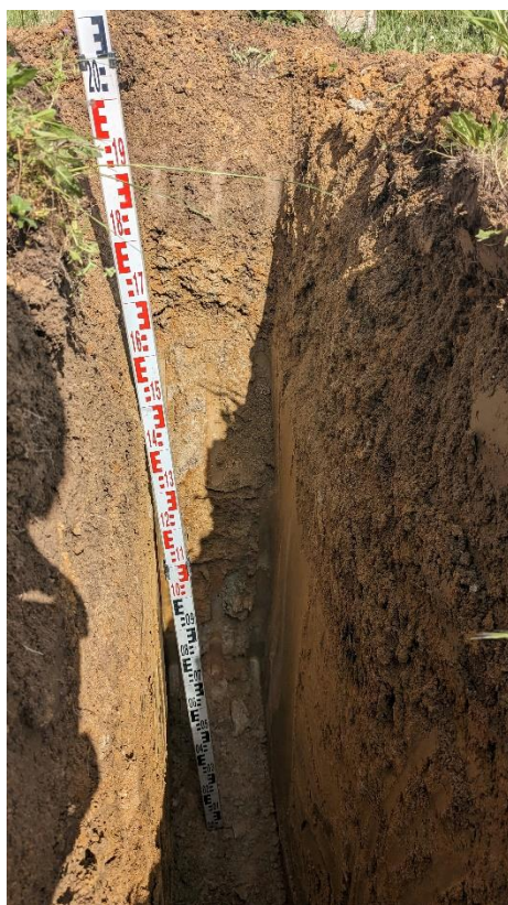
PM3– Traces d'oxydo-réduction dans les échantillons prélevés (en haut) et dans la fouille (en bas)
