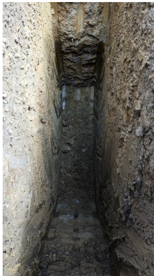
PM1 – Echantillon avec traces d'oxydo-réduction
