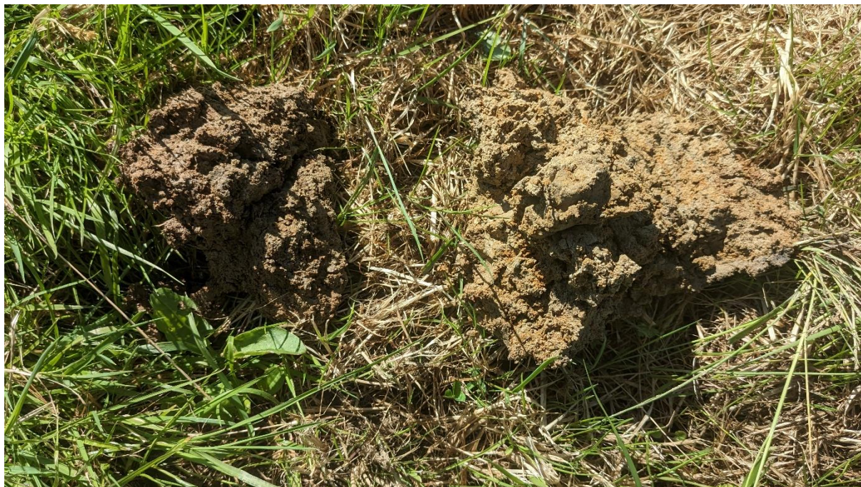
PM1 – Echantillon avec traces d'oxydo-réduction
